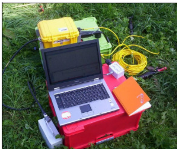
Figura 2: Strumentazione utilizzata per la prova MASW.
